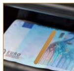
Der Magnetsensor prüft die magnetischen Eigenschaften des Sicherheitsfadens.
